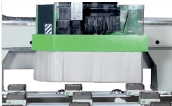
**Bandas laterales** para la protección del grupo operador, móviles para trabajar a la máxima velocidad con total seguridad.
