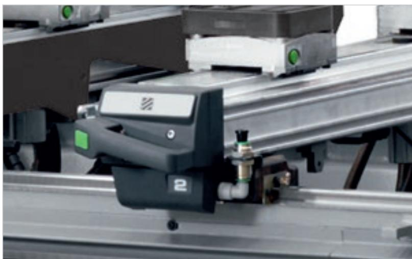
Salida de vacío auxiliar ergonómica para plantillas personalizadas.
